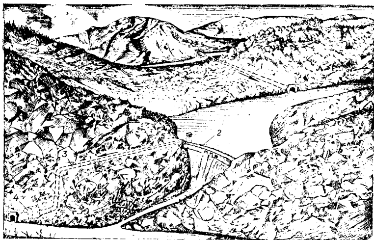
Рис. 22. Схема Ладжанури ГЭС: 1—переброска стока р. Цхенис-Цкали в р. Ладжанури; 2—арочная плотина на р. Ладжанури; 3—напорный деривационный тоннель; 4—здание ГЭС
