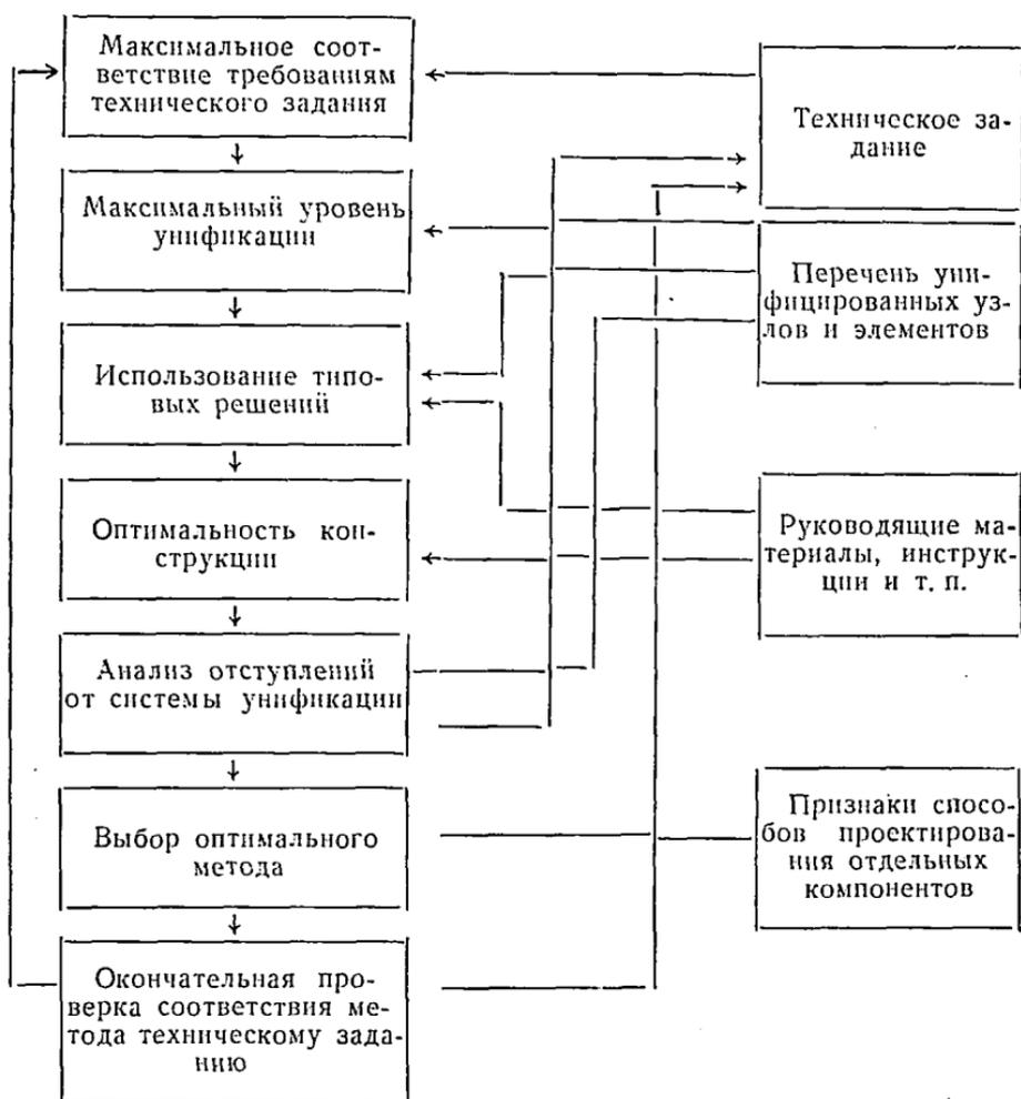
Рис. 70. Алгоритм проектирования электрооборудования станка (линии)
