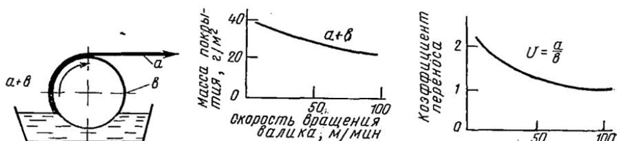
Рис. 13. Зависимость массы покрытия и коэффициента переноса от скорости вращения валика
