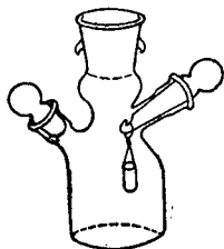
Рис. 10.3. Модифицированный реакционный сосуд для микрогидрирования.
