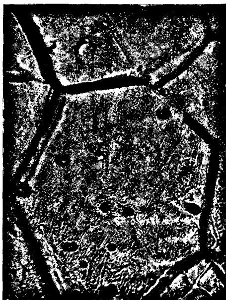
Протравлено HCl при 1120°; увеличение 330.
