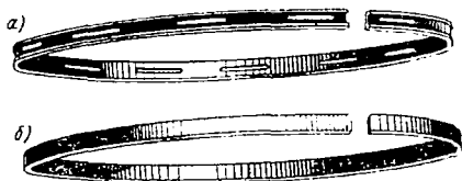
Рис. 21. Поршневые кольца: а — уплотняющие; б — маслосъемные
