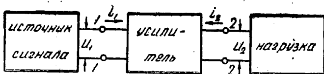
Рис. 1.1. Функциональная схема усилительного устройства.
